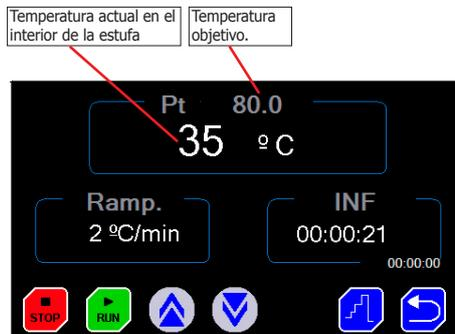
Fig 7.3.1. Pantalla de trabajo con una sola temperatura
